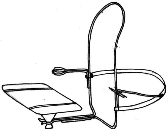
Для изготовления столика необходимо: 180 см алюминиевого одножильного провода в изоляции с диаметром жилы 4-5 мм; два планшета из одинарного гофра картона размером 25 x 20 см; одну пластиковую бутылку (1,5 – 2 литра); 100 см узкой резинки; 60 см широкой резинки; один простой карандаш; один маленький гвоздик диаметром не более 0,1 см. Необходимые инструменты и расходные материалы: нож канцелярский, нож простой, степлер, иголка с ниткой, изолента.
